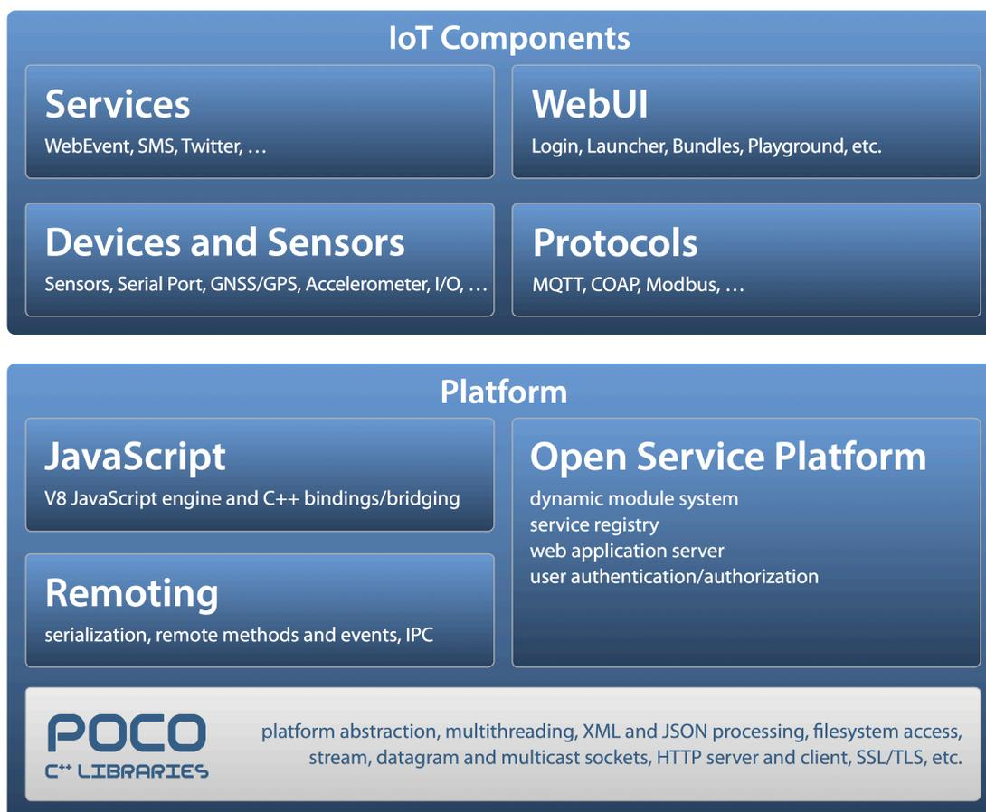
Abbildung 4: Aufbau von *macchina.io*, einer Software Plattform für IoT Gateways
